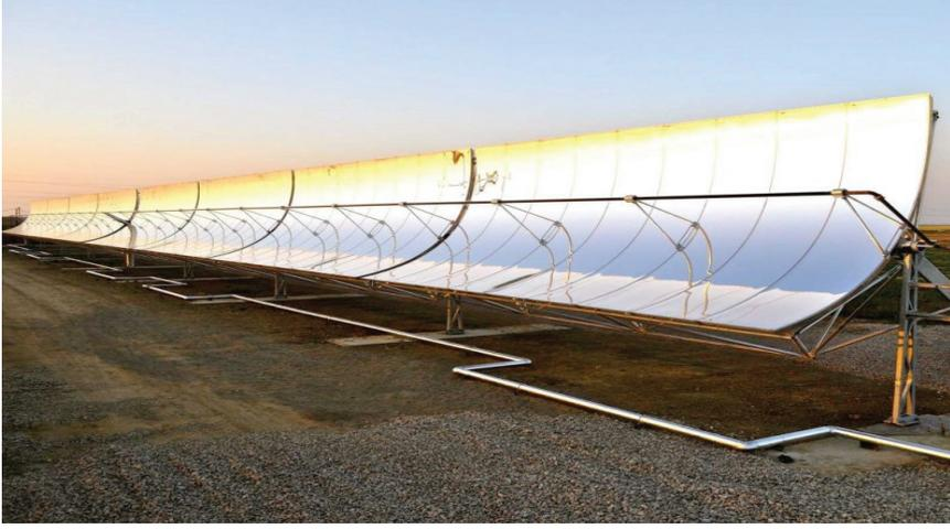
صورة لتقنية تحلية المياه بالطاقة الشمسية Water FX التي تستخدم أشعة الشمس لإنتاج الحرارة لتنقية المياه سواء أكانت مالحة أو ملوثة
